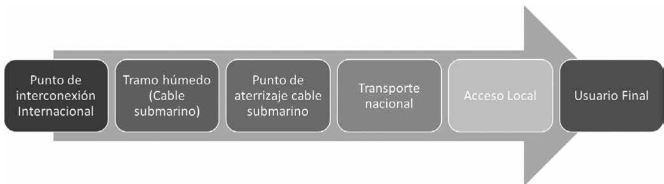
Figura 2.14. Servicio mayorista de acceso y transporte de capacidad de salida internacional: Cadena de elementos vinculados para la prestación del servicio a internet
